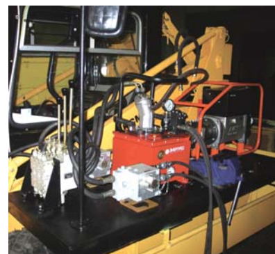
На фото: модель НГР-1,6ДД10-1 подключенная в гидросистему вспомогательной путевой машины
