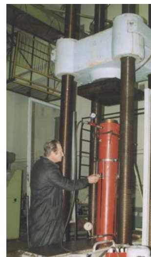
На фото: модель НЭЭ-1,6И63Т1 на испытании гидроцилиндра ЦС200Г1250
