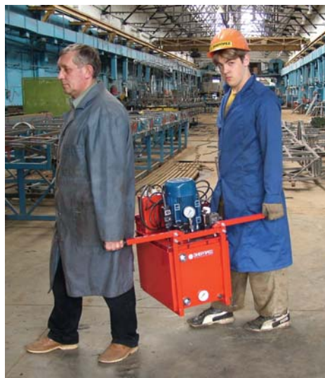
На фото: НЭЭ-0,8Г40Ф1- ТС с термометром и складывающимися ручками
