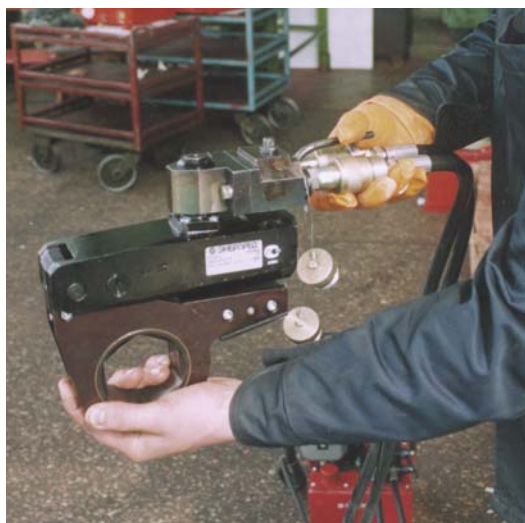
На фото: гайковерт ГКГ500 со встроенным распределителем ГР-2ГР-1, подключенный к станции ВНЭР-1,6А10Т1-М
